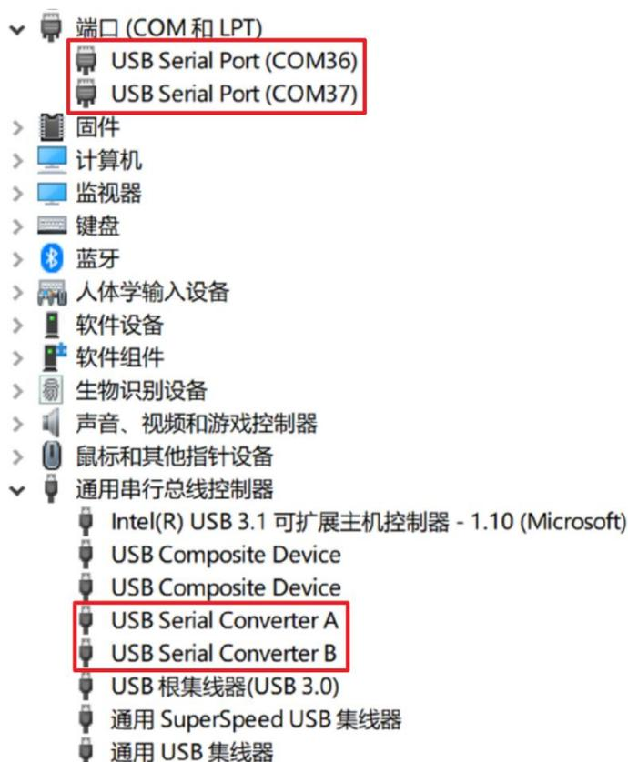
图 13-10 设备管理器中显示两个串口
